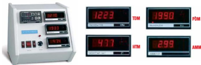
TDM 模块：转速数字显示模块，带转速传感器；
