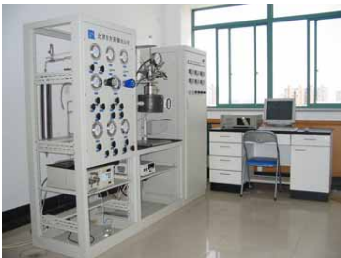
高温高压超临界反应及计算机控制系统
