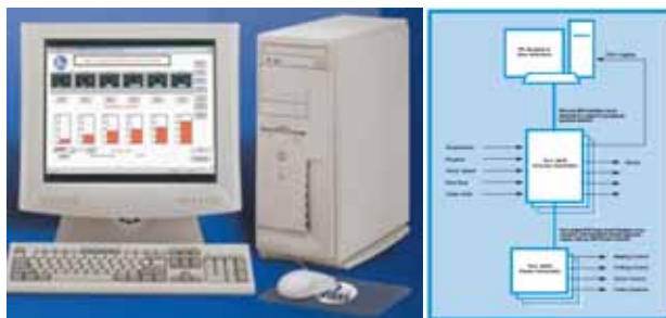
PARR 4870 反应釜控制--计算机数据采集和控制系统
