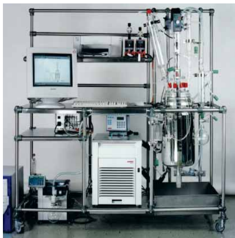
实验室通用性 20 升玻璃反应釜
