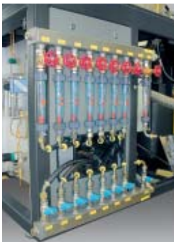
冷却水供应装置
